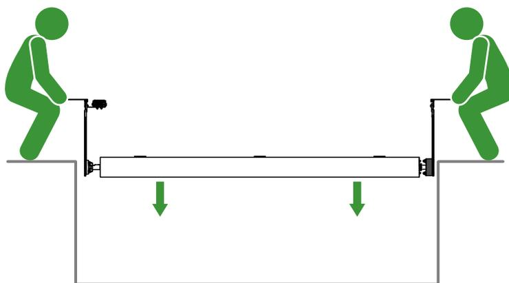
Si besoin, ajuster le niveau à l'aide des cales accordéon fournies.
