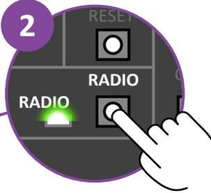
2 Appui long sur RADIO jusqu'à clignotement Appairage en cours
