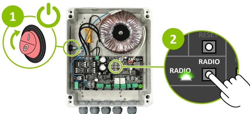
Récepteur radio intégré dans le Coffret.
