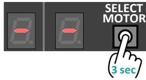
Appui 3 sec. pour activer la sélection du moteur puis appuis courts pour sélectionner le moteur.
