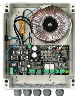
Récepteur radio intégré dans le coffret.
